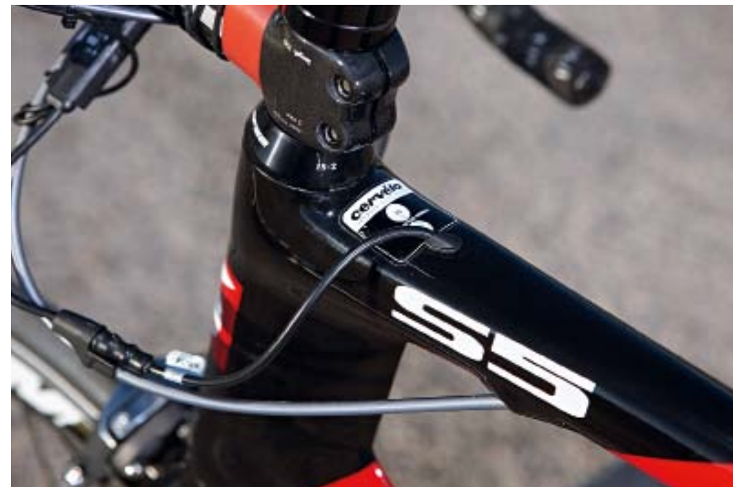
◀ Bei der Di2-Schaltung gibt es nur ein dünnes Kabel, das hinter dem Vorbau im Rahmen verschwindet.
