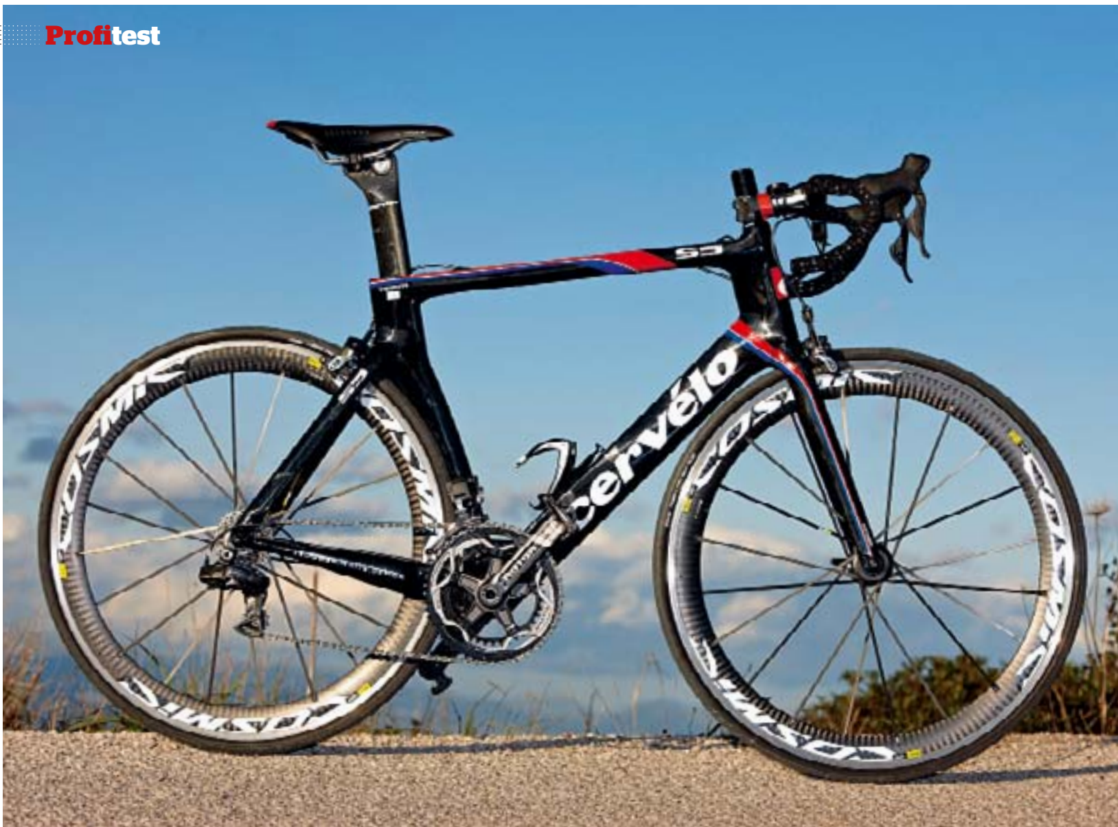
▲ Das S5 soll in erster Linie schnell sein, nicht schön. Jedes Detail des Rahmens ist auf optimale Aerodynamik ausgerichtet.
