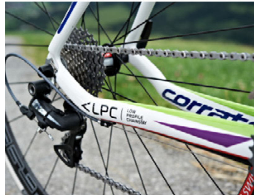
◀ Die tiefer gelegten Streben verhindern ziemlich wirkungsvoll nerviges Ketten-schlagen.
