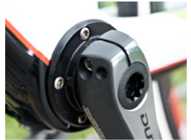
▲ „UBBS“ nennt Corratec seinen Innenlagerstandard, der alle handelsüblichen Kurbeln aufnehmen kann.
