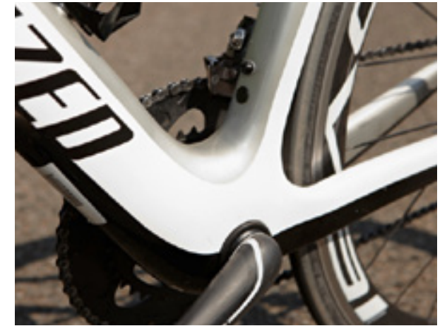
▲ Der massive Tretlagerbereich sorgt für beste Steifigkeit beim Antritt. Unter der Flaschenhalterbohrung erkennt man den Eingang zum Di2-Tunnel.
